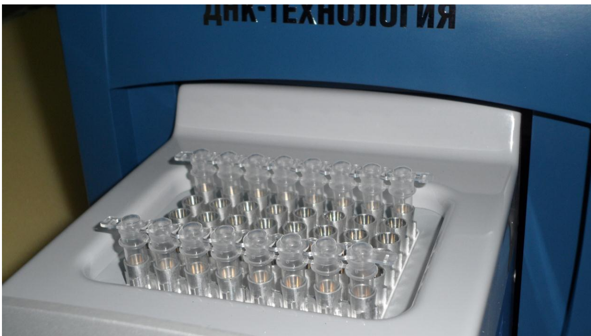
Рис.25. Внешний вид матрицы термоблока в выдвинутом положении.
