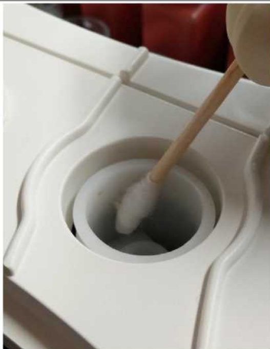
Рисунок 9.4.2-1 Очистка ванночки для промывки
