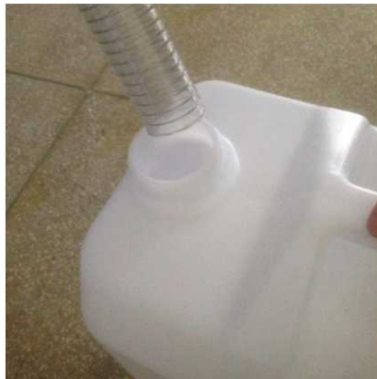
Рисунок 9.3.3-4 – Извлечение трубки для жировых отходов
