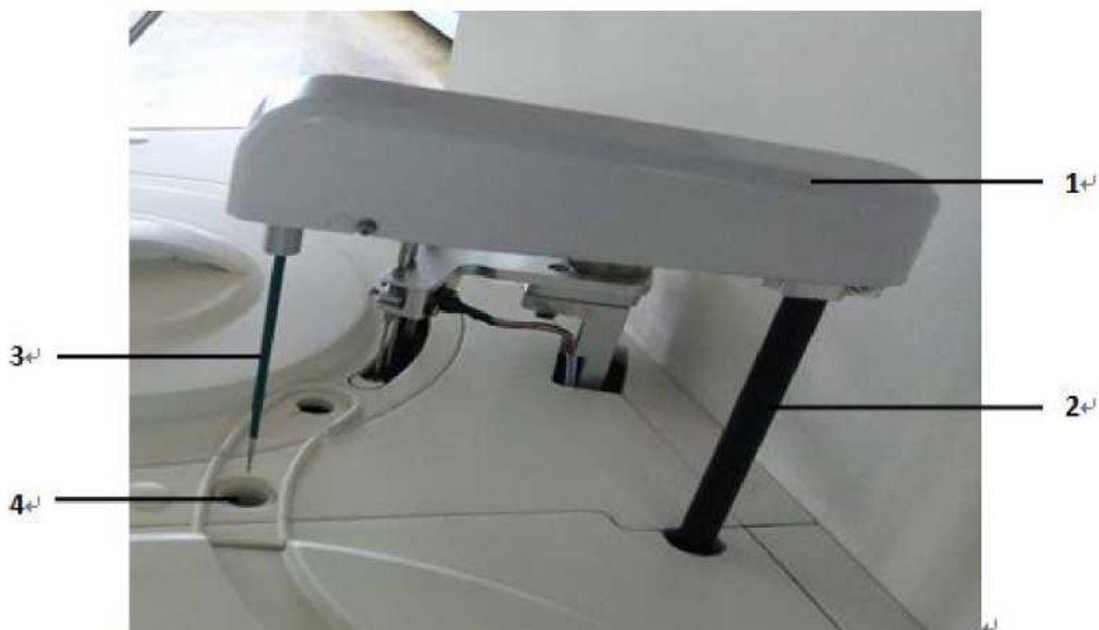
Рисунок 1.6.3 Механизм добавления реактива
