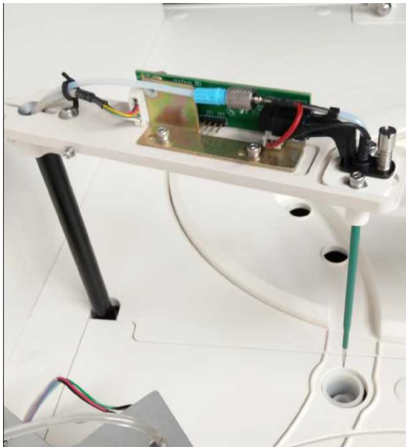
Рисунок 9.6.3-5 Установка зонда для реактива
