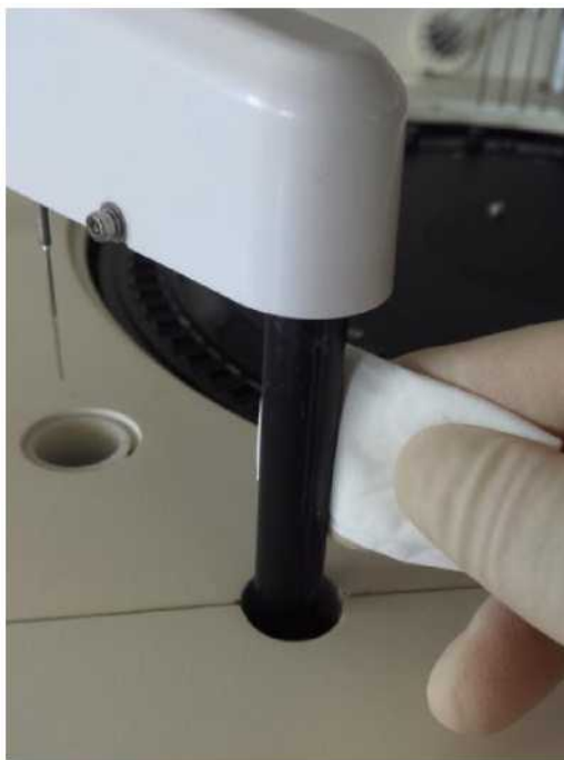
Рисунок 9.5.5 Очистка ведомого вала мешалки
