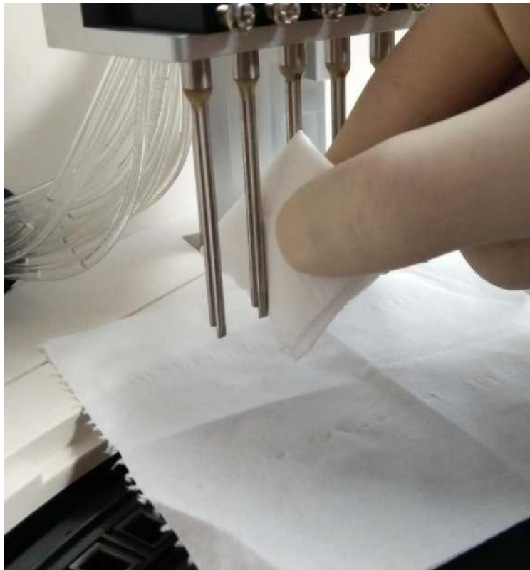
Рисунок 9.4.3 Очистка промывочного механизма
