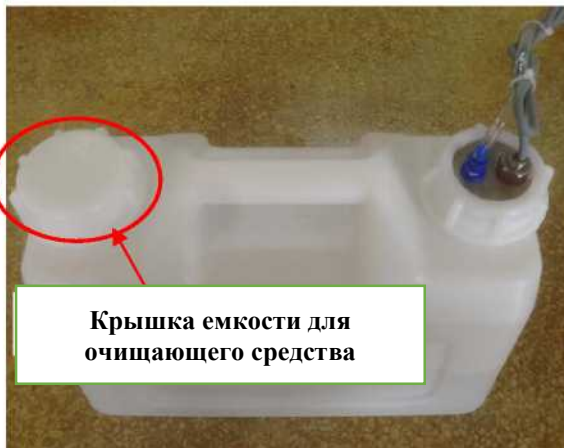
Рисунок 9.3.2-1 Крышка емкости для очищающего средства
