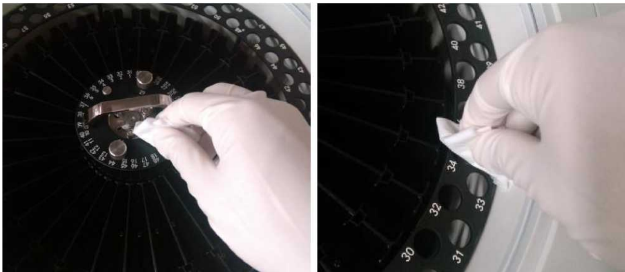
Рисунок 9.4.4 Очистка лотка для образцов и реактивов
