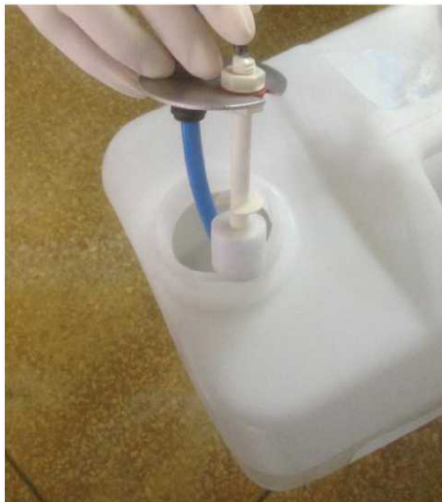
Рисунок 9.5.3-2 Извлечение компонента BNC
