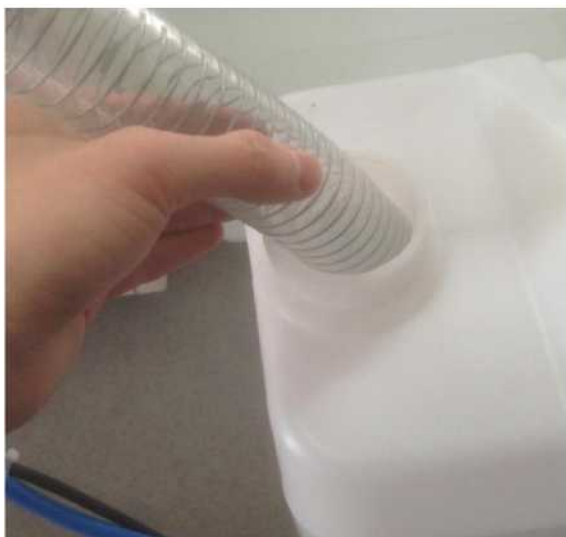
Рисунок 9.3.3-4 – Извлечение трубки для жировых отходов
