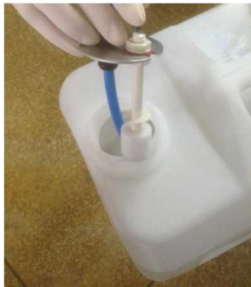
Рисунок 9.3.3-2 Отвинчивание крышки BNC Рисунок 9.3.3-3 Извлечение компонентов BNC
