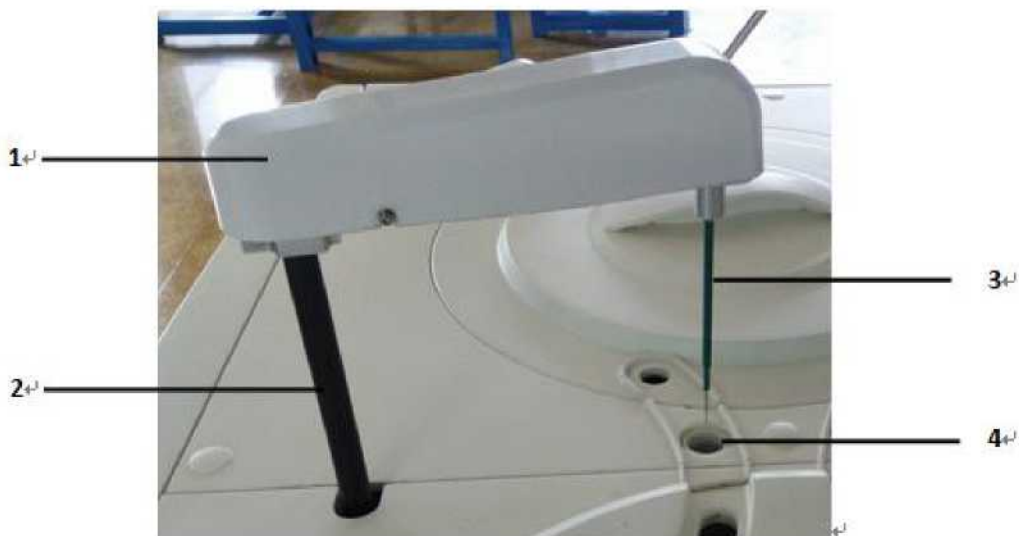
Рисунок 1.6.2-2 Механизм добавления реактива/пробы
