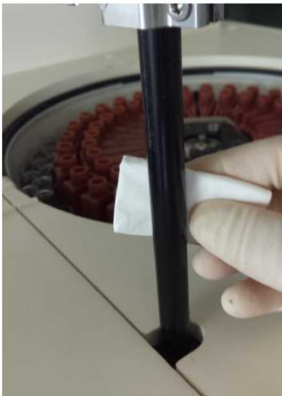
Рисунок 9.5.4 Очистка ведомого вала
