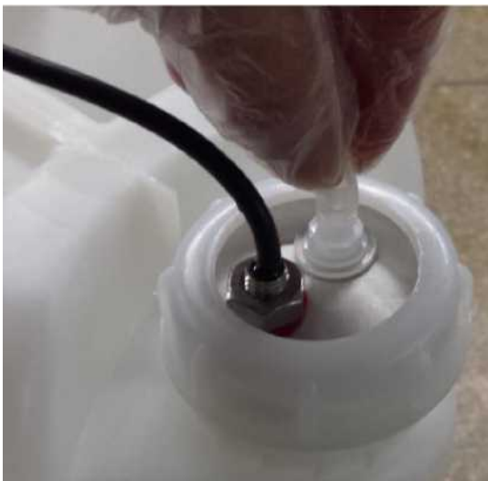
Рисунок 9.3.1-2 Извлечение трубки для дистиллированной воды.
