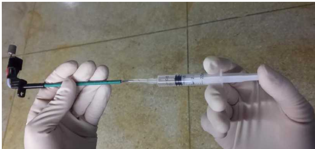
Рисунок 9.6.3-4 Прочистка зонда для реактива
