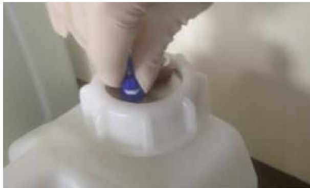
Рисунок 9.3.2-2 Отвинчивание трубки для очищающего средства
