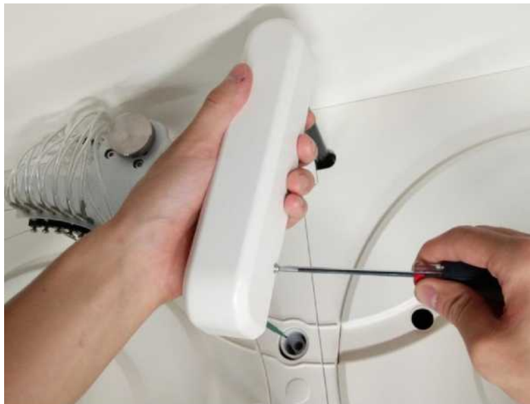
Рисунок 9.6.3-1 Снятие крышки зонда для реактива
