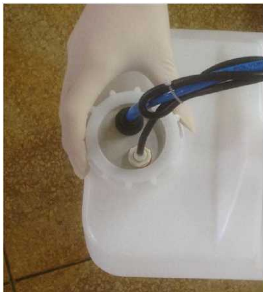
Рисунок 9.3.3-2 Отвинчивание крышки BNC Рисунок 9.3.3-3 Извлечение компонентов BNC
