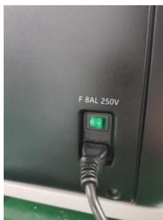
Сверху вниз: выключатель питания, предохранитель, разъем для шнура питания
