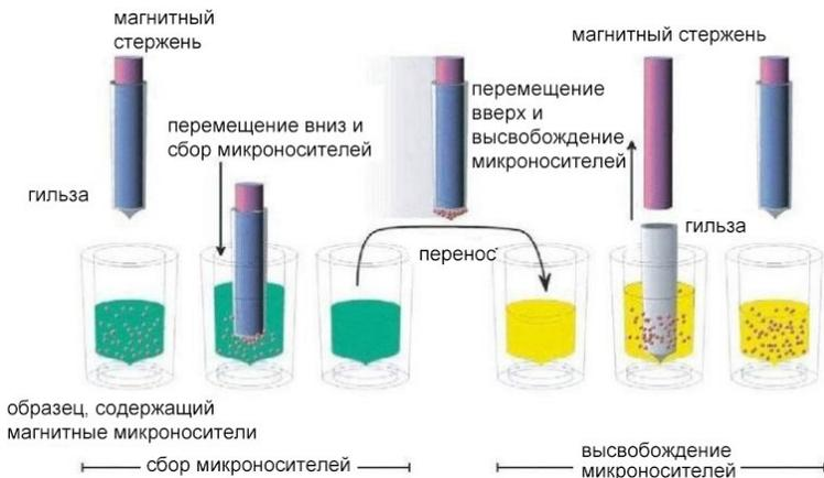
Рис. 1. Принцип экстракции на SSNP-3000A
